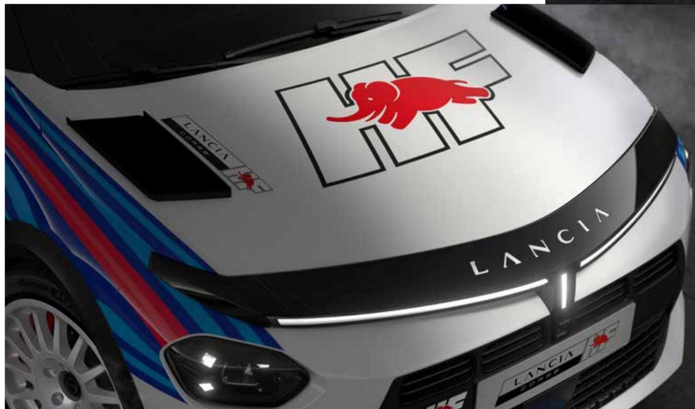
Der Lancia Ypsilon Rally 4 HF wird von einem 1,2-Liter-Turbomotor mit 3 Zylindern angetrieben, der 212 PS leistet. Er verfügt über Frontantrieb, ein mechanisches 5-Gang-Getriebe und ein mechanisches Sperrdifferential und ist damit ideal für Rallye-Enthusiasten und ernsthafte Teilnehmer an der R4-Klasse und an Meisterschaften mit Zweiradantrieb.
