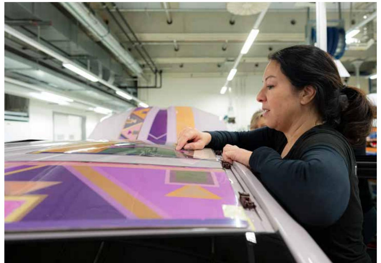
Um Mahlangus aufwendige Ornamente nachzubilden, verfügt der BMW i5 Flow NOSTOKANA über 1.349 einzeln ansteuerbare Foliensegmente, die von der BMW Group in Zusammenarbeit mit E Ink entwickelt wurden. Die sich schnell weiterentwickelnde Farbwechseltechnologie, die bereits bei früheren BMW Modellen zum Einsatz kam, ermöglicht mehr Farben und Muster bei gleichzeitig verbesserter Haltbarkeit.
