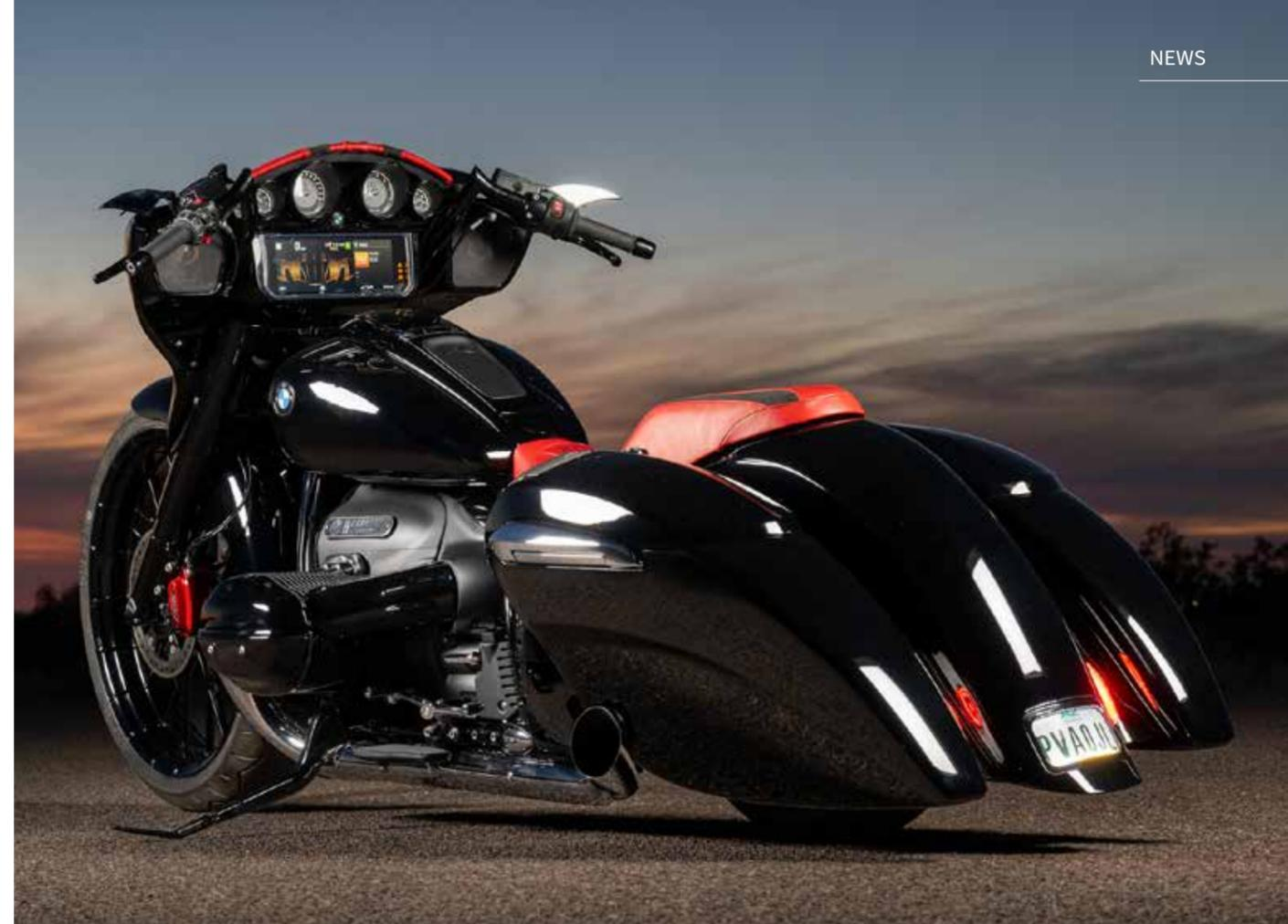
Als die Konstruktion Gestalt annahm, ordnete Yaffe die originalen R 18-Rückleuchten in die handgefertigten Füllbleche ein und arbeitete einen Bereich für das Nummernschild in den Kotflügel im klassischen Hot Rod-Stil ein. Außerdem dehnte er die originalen R 18-Seitenverkleidungen, um ihre ursprüngliche Form zu erhalten und mehr Fläche abzudecken, damit der Blick in die Taschen fließen kann.
