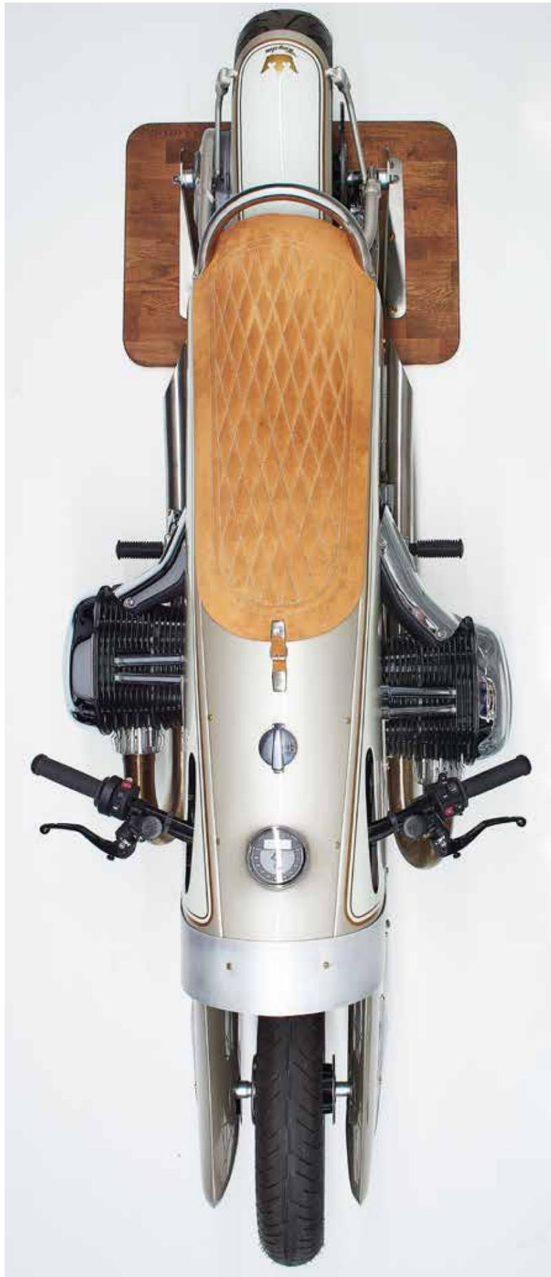
Dirk Oehlerking und sein Team haben das 2 mm dicke Aluminiumblech geschnitten, gebogen und geformt, um den 8-Liter-Kraftstofftank und die Karosserieteile des R18 The Crown zu formen. Während Motor und Hinterradaufhängung dem Originaldesign treu bleiben, sind die beiden Edelstahl-Auspuffkrümmer komplett handgefertigt.
