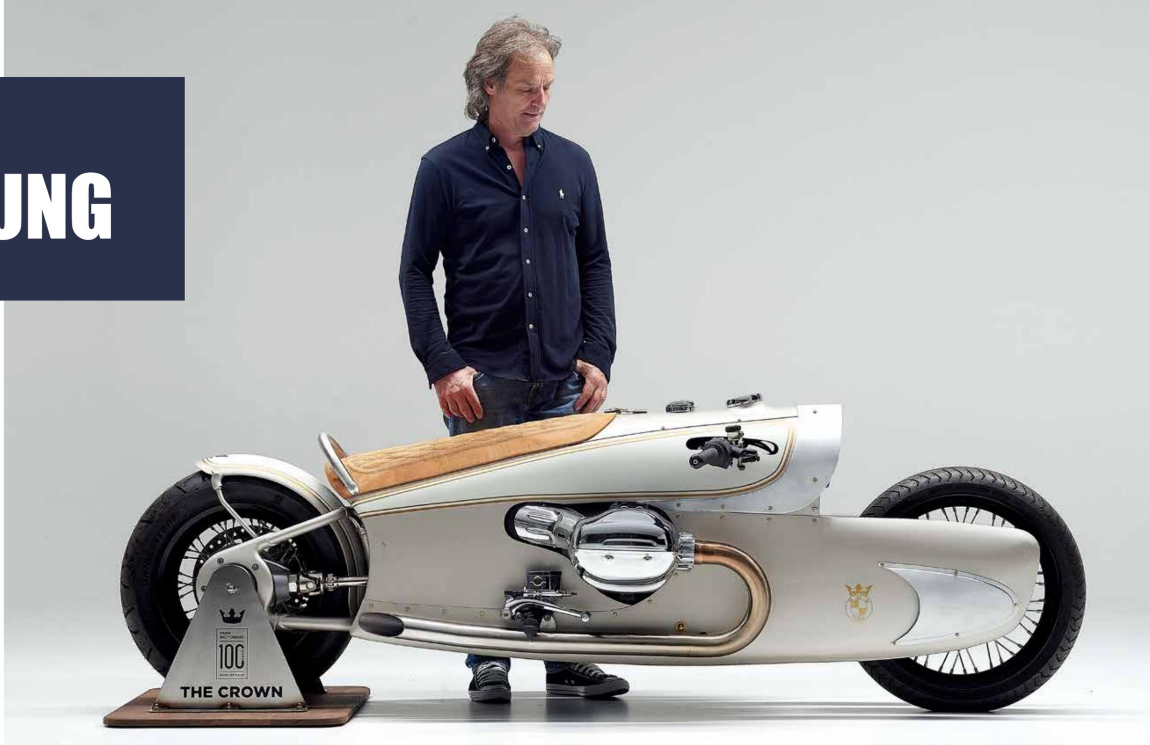
BMW Motorrad feiert sein 100-jähriges Jubiläum und präsentiert das Design des Kingston Custom-Gründers Dirk Oehlerking und seine Interpretation des R18 Ride with The Crown. Der große Boxer verfügt über eine gebogene Aluminiumplatte über der Vorderradaufhängung und eine Zweiarmschwinge mit Mittelstrebe.
