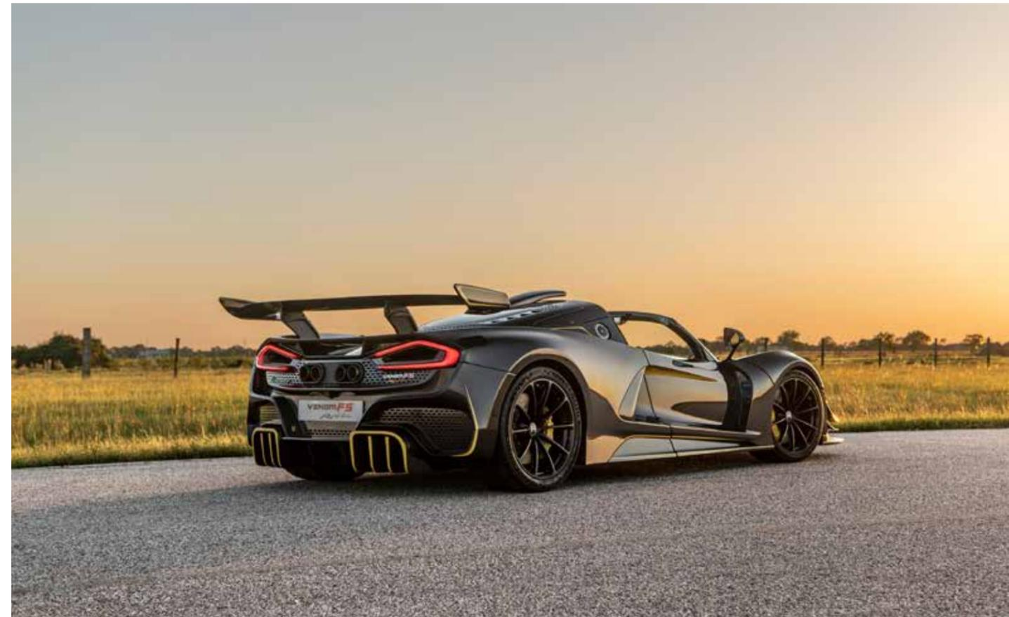
Im Gegensatz zum Coupé wurde das Dach des F5 Revolution Roadster mit einer abnehmbaren Platte aus steifem Kohlefaser-Verbundwerkstoff neu gestaltet. Das einteilige Dach ist gegen Witterungseinflüsse isoliert und mit weichem Alcantara bezogen. Das leichte Dachpaneel wiegt nur 8 kg und kann von einer Person problemlos ein- und ausgebaut werden.
