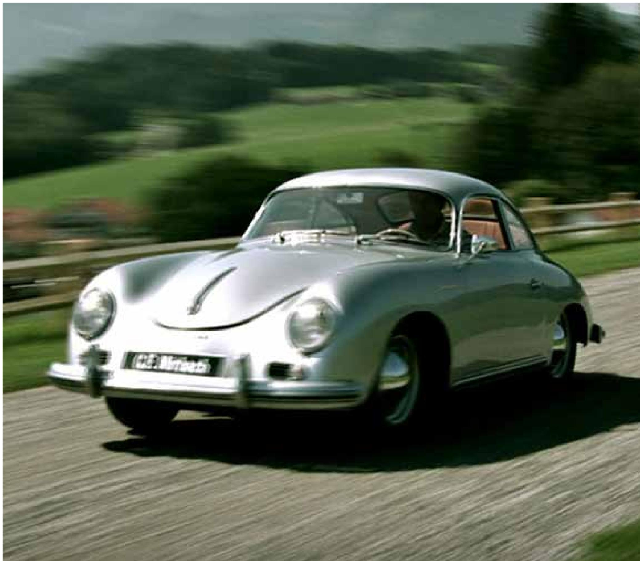
Unter der Haube schlummern 110 PS, die den Wagen auf eine Höchstgeschwindigkeit von 200 Stundenkilometern bei 6400 Umdrehungen pro Minute bringen. Bei einem Leergewicht von 880 Kilogramm ergibt sich ein Leistungsfaktor von 8 Kilogramm pro PS.
