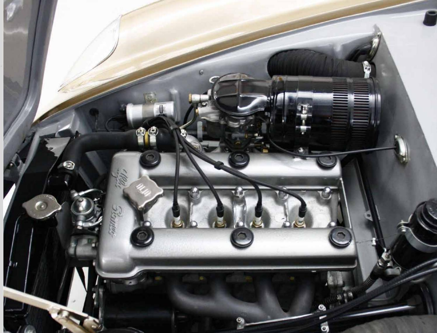
Das Herz dieses Prototypen entspricht dem 1954 mit den Giuliettas vorgestellten Alfa Romeo Vierzylinder-Reihenmotor mit 1290 ccm und hat eine Leistung von 65 PS bei 4500 U/min. Damit ist der kleine Alfa Romeo äußerst spritzig und kraftbetont.
