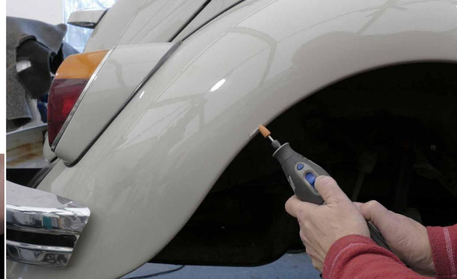
Ist die Spachtelmasse durchgehend ausgehärtet, kann mit feinem Schleifpapier die Stelle glatt geschliffen werden. Das Schleifen muss trocken erfolgen, denn Polyesterspachtel ist hydrostatisch und saugt das Wasser ein. Dies ist für die anschließende Lackierung ungünstig, da der Lack an dieser Stelle nicht mit dem Untergrund bindet und Blasen bildet.
